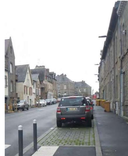
Figure 211 : Stationnement en pavés joints enherbés rue de la Corderie (Source : EGIS, janvier 2022)
