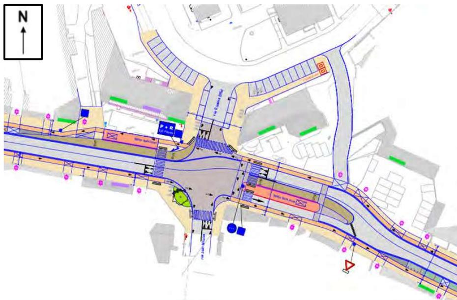
**Figure 195 : Insertion axiale dans l'aménagement du carrefour Saint-Jouan**
